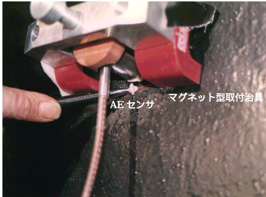
図2 AE センサの設置
