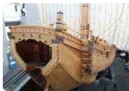
図 8-9 弁才船の船尾 （出典：なにわ海の時空館の浪華丸）
