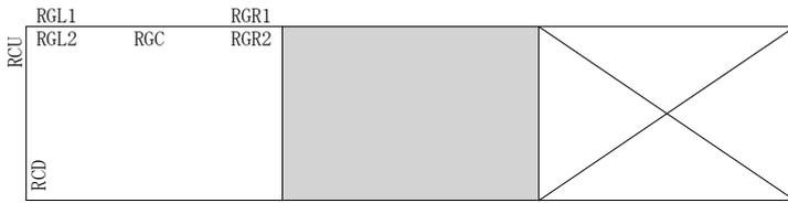
RGL1 : 梁左端のせん断に関する検定比. RGL2 : 梁左継手のせん断に関する検定比 (S・SRC)
