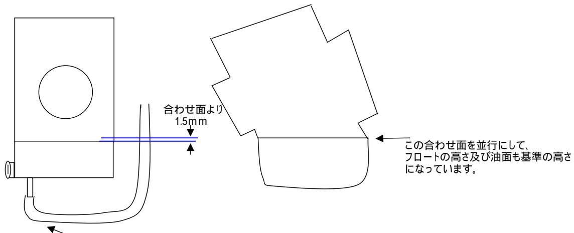
ガソリン排出のニップルに透明なホースなどを付けて図のようにする
