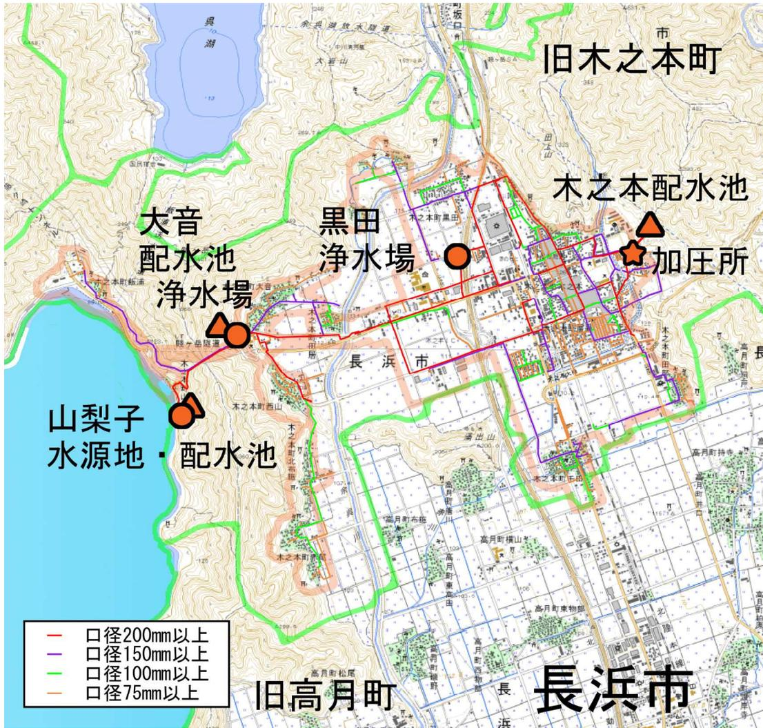
図2-5-8 配管図(余呉木之本簡易水道)
