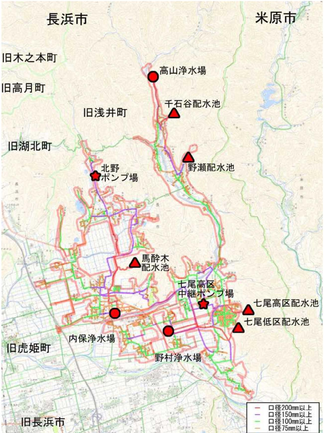
図2-5-5 配管図(湖北簡易水道・高月上水道事業)
