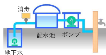
川道・錦織浄水場処理フロー
