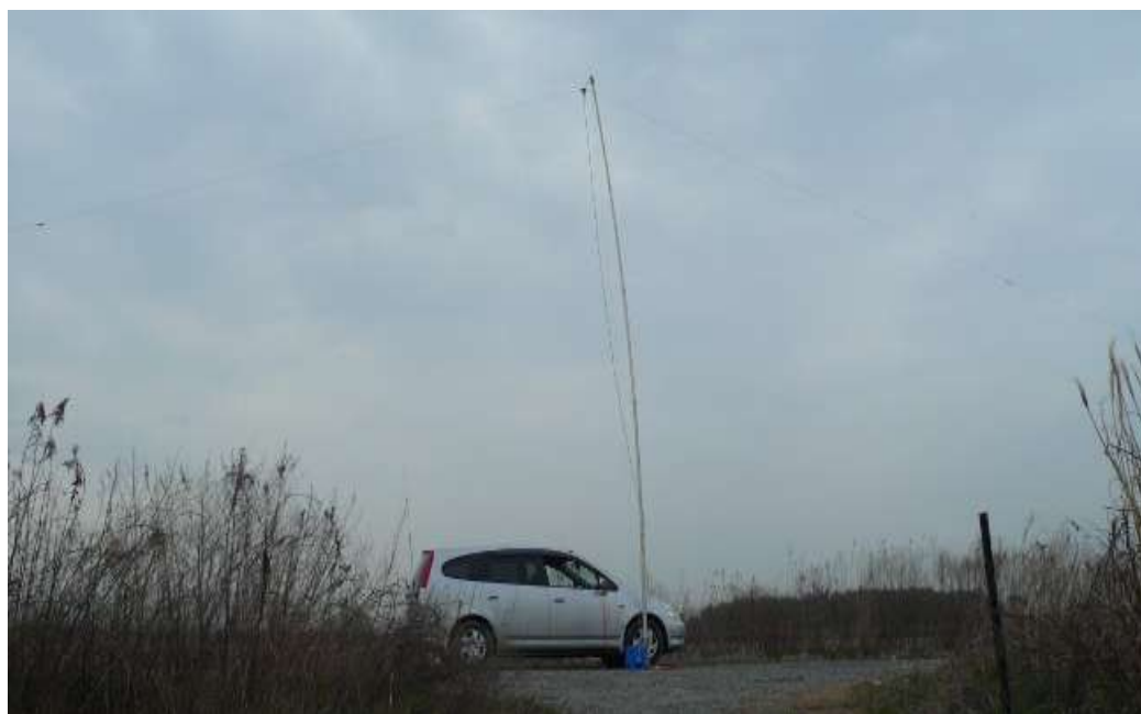
移動運用風景 (160/80/40m のギボシ型フルサイズ DP 10m 高さ)
