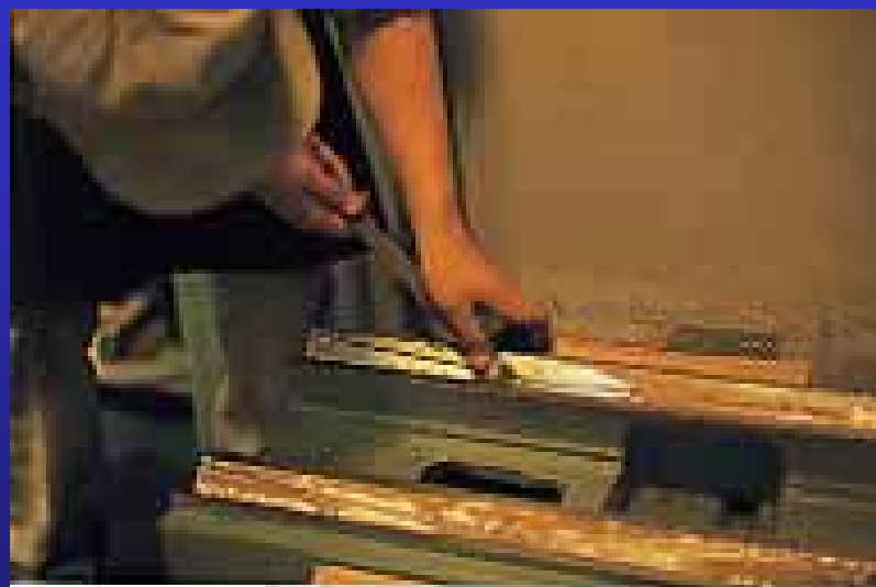
キサゲ作業で機械の平面を仕上げる。
