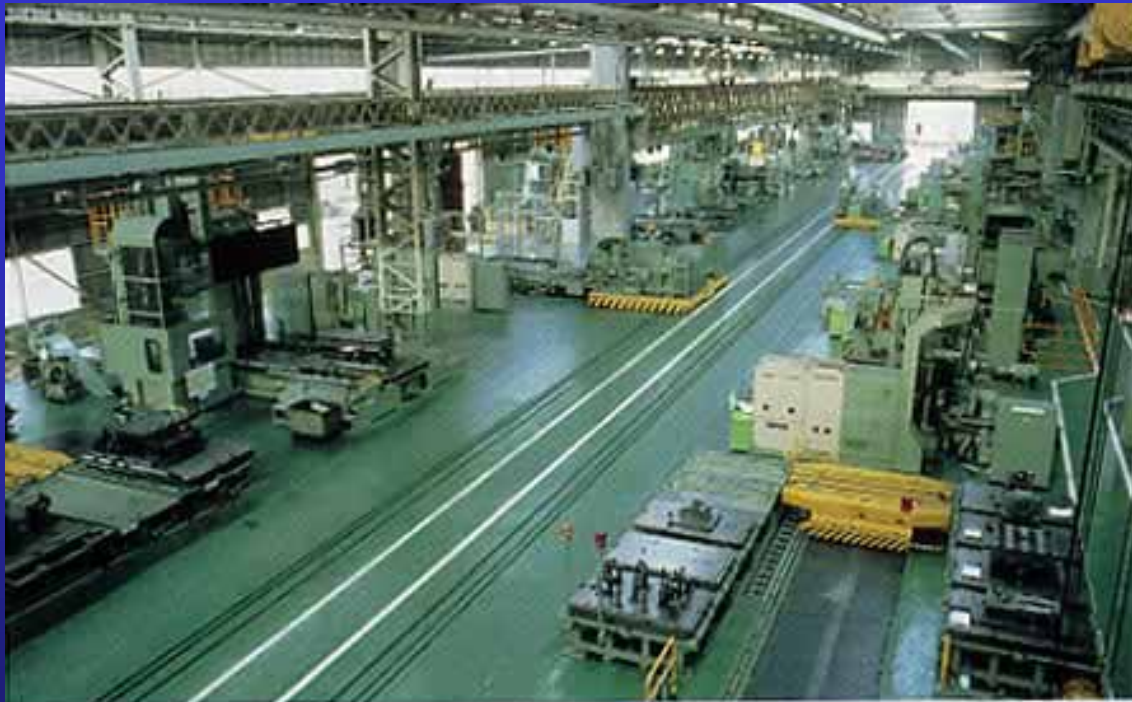
図1 ●三菱重工の部品加工 FMS
