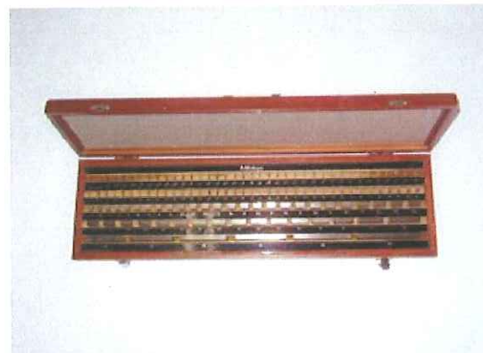
写真-48 122個数のゲージブロック(1999年開発)
