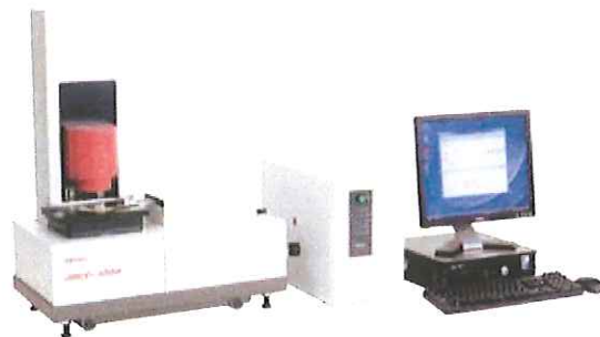
写真-43 演算形ゲージブロック自動検査機
