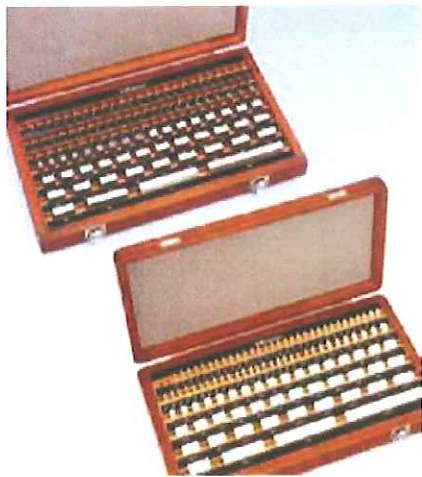
写真-36 ゲージブロック(ミットヨ製)鋼製(奥)及びセラミックス製(手前)
