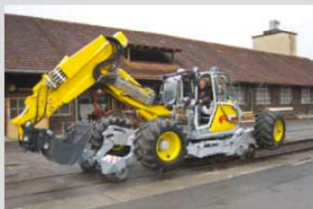
レール上でのエクスカベータの使用
