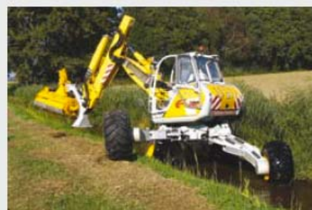
水路中または堤防斜面での草刈り
