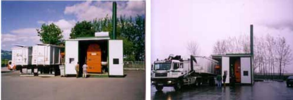
これはMAWERA社がユニットで販売しているボイラー装置ですが、左側に2台繋がっているのはアームロール車の荷台の部分です。これを投入装置に繋ぐと自動的に中のチップがボイラーに送り込まれます。
