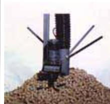
これはKWB社の家庭用チップ・ペレット兼用ボイラーのカタログから取った写真です。左上はペレットのボックスを備えたもの、右上はチップ貯蔵庫(左下)からチップを送り込む装置をつけたタイプです。円板についてはばね状のもので貯蔵庫のチップを掻き出し、スクリュー状の送り装置で搬入します。右下は吸入式のもので、このようにいろいろなタイプが考案され、実用化されております。
