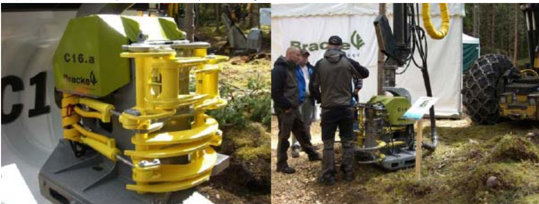
図 5 マルチ・ステム・ハーベスタヘッド
