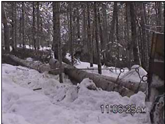
写真-7 荷掛け作業
