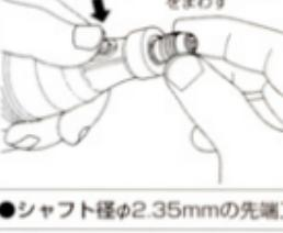
●ロックボタンを軽く押さえながら、チャック部を指で回し、回転輪が固定される位置を探し、固定します。
