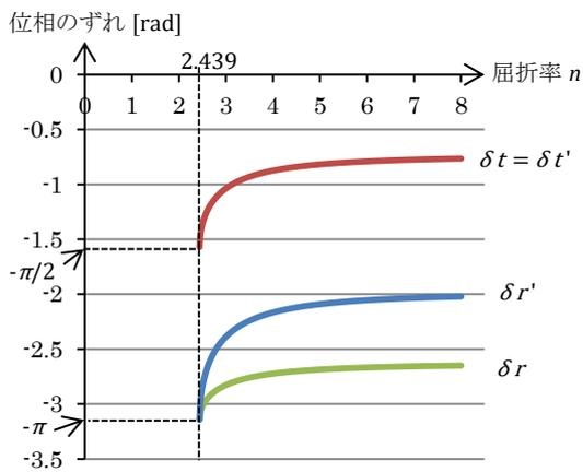
図2 半透鏡での位相のずれ(S偏光)
