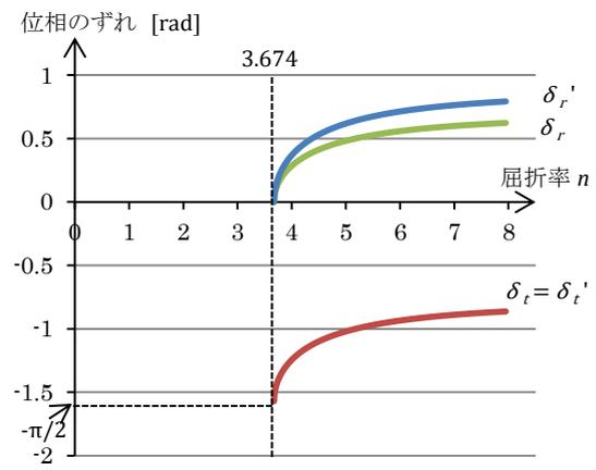
図4 半透鏡での位相のずれ(P偏光)
