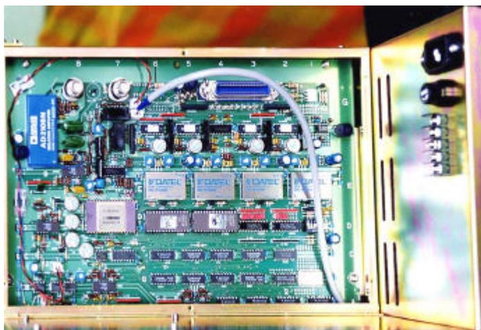
アナログとデジタルを組み合わせた信頼性の高い産業用制御装置の例です。シリコンの成長を制御する電源の制御を行う装置です。
